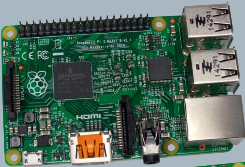
Der Raspberry Pi hat neben den I/O-Pins noch einen Anschluss für Kameras (CSI) und Displays (DSI).
