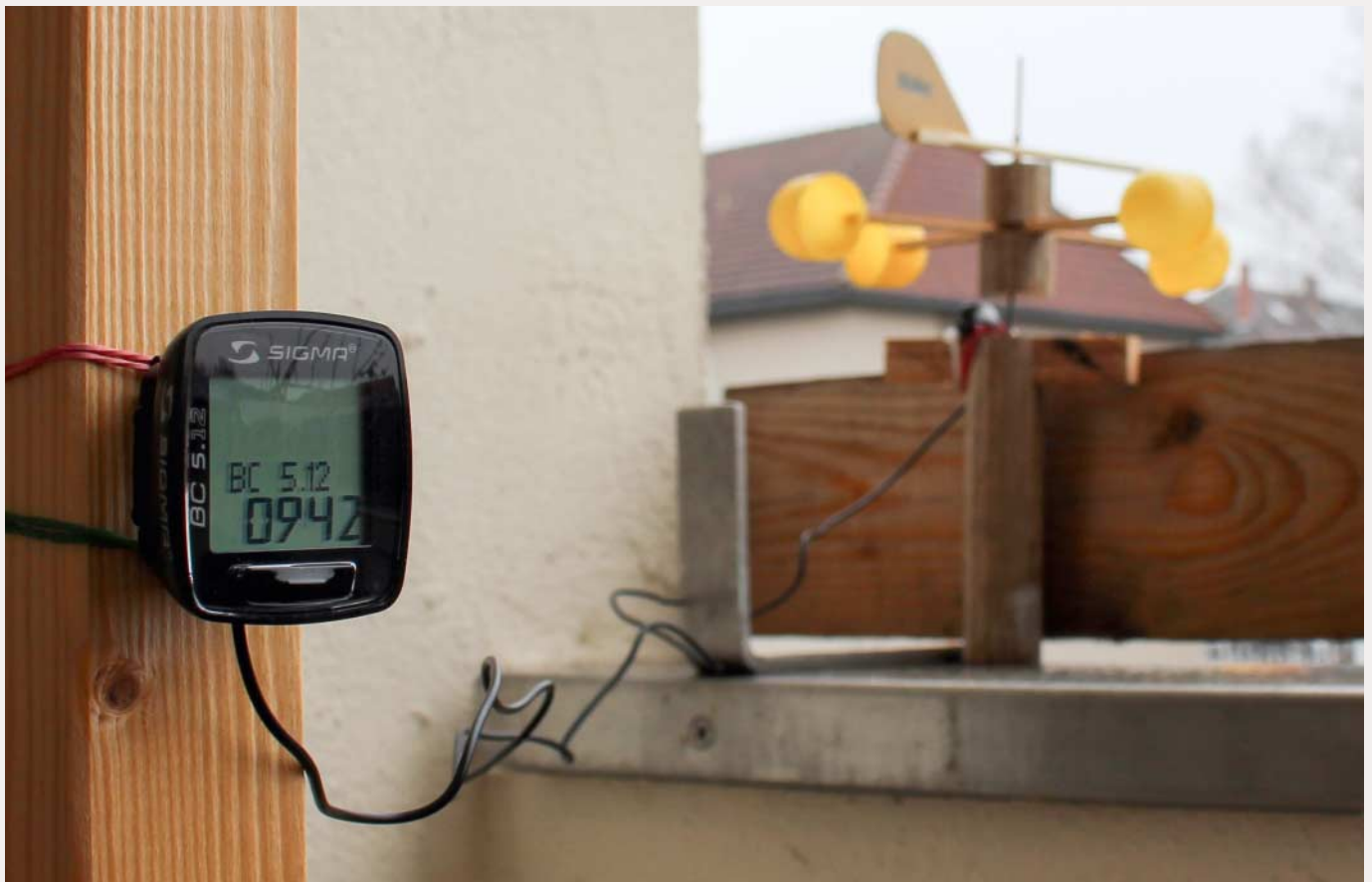
Ob mit oder ohne Kabel – bei stationärem Einsatz lässt sich der Fahrradcomputer auch abseits des Anemometers befestigen.
