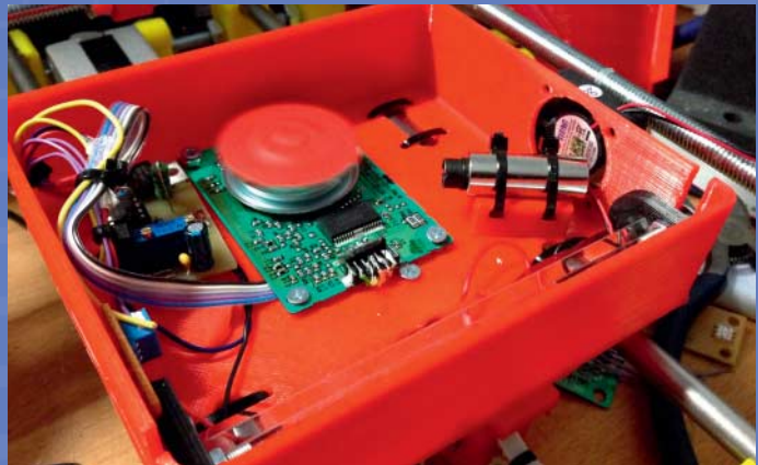
Der Polygonspiegel rotiert und erzeugt dadurch eine Laserlinie. Ein solches Modul lässt sich samt Steuerelektronik aus einem herkömmlichen Laserdrucker gewinnen.
