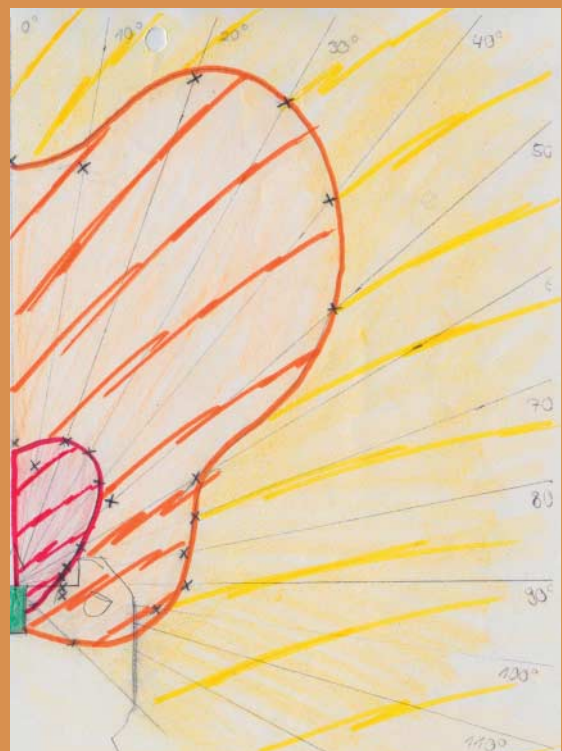
Das Gesichtsfeld des Spybotics zeigt klar die Ausrichtung der Infrarot-Empfänger sowie die Ungenauigkeit der Ortung.
