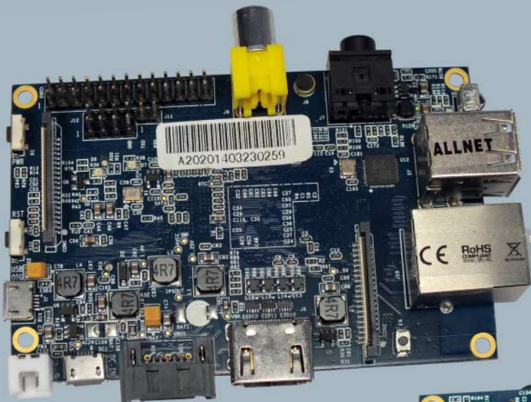
Die schwarze Buchse unten links neben dem HDMI-Port ist der SATA-Anschluss.
