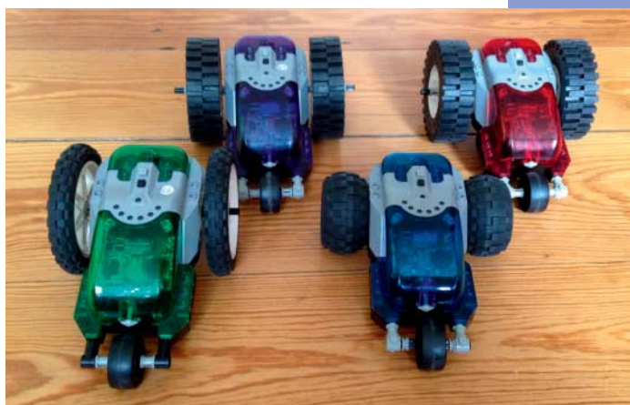
Am besten funktionierten unsere Experimente mit großen Hinterrädern und nur einem, möglichst glatten Vorderrad, damit sich die Roboter gut drehen können.
