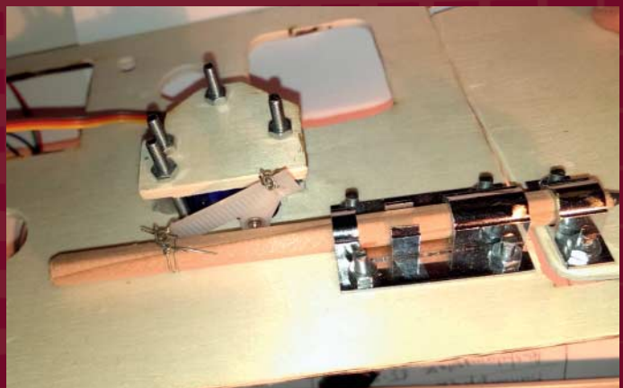
So einfach konstruiert man ein elektronisches Schloss: Servomotor, Metallteile von einem Türscharnier und ein zufällig herumliegender Bleistift als Riegel.
