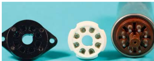
Links eine Chassis-Oktalfassung, in der Mitte eine Oktalfassung für die Platinenmontage, rechts eine EL34 mit dem passenden Oktalsocket
