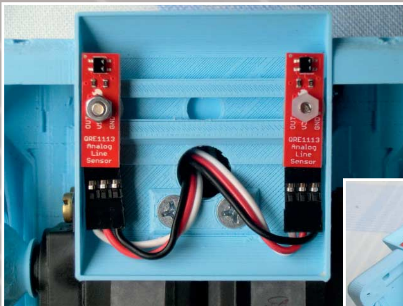
Für die Liniensensoren ist eine eigene Haltevorrichtung vorgesehen.
