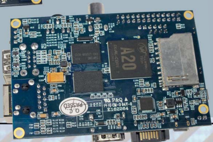
Der Banana Pi hat einen Slot für normale SD-Karten.
