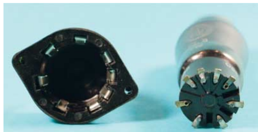
Eine Außenkontaktfassung, wie sie bis zum Ende des zweiten Weltkriegs üblich war, daneben eine EL8 mit dem passenden Außenkontaktsocket
