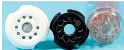
Zwei Novalfassungen unterschiedlicher Bauart ECC803 mit Novalsocket, daneben die passende Röhre. Oktal- und Novalfassungen sind heute gebräuchlich.
