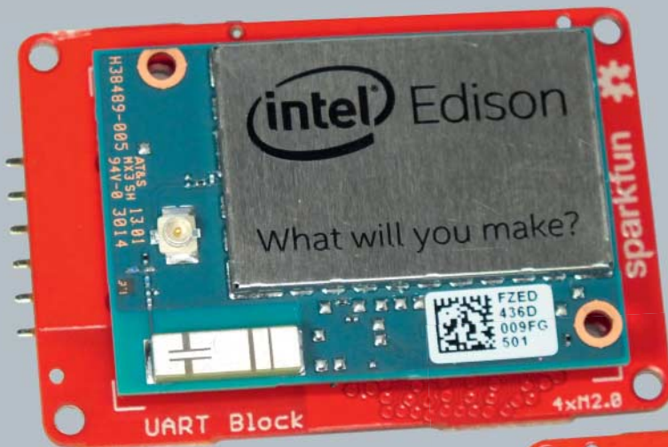
Der Edison ist nur die kleine grüne Platine. Er steckt auf einem Block-Modul von Sparkfun.
