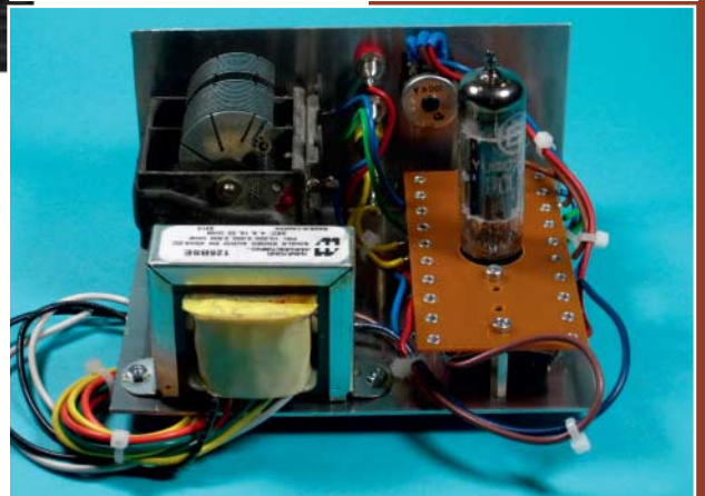
Das Audion als Aufbau auf einem Testchassis, einmal von vorne und einmal von der Rückseite gesehen
