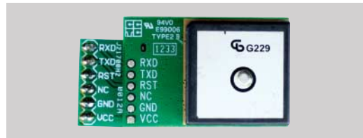
Der Chip in Originalgröße mit der Antenne rechts und dem Adapter links
